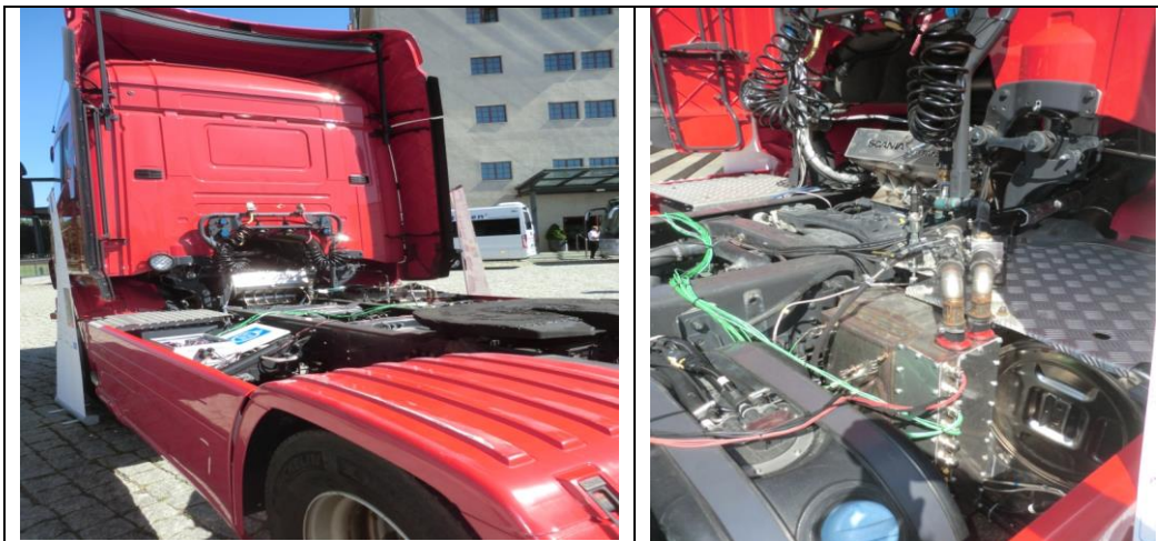
Fig 1. Schwerlastfahrzeug mit thermoelektrischem Test-Generator
